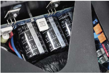
Część elementów filtrujących napięcie umieszczono na płytkach końcówek mocy, część na dodatkowych modułach.
