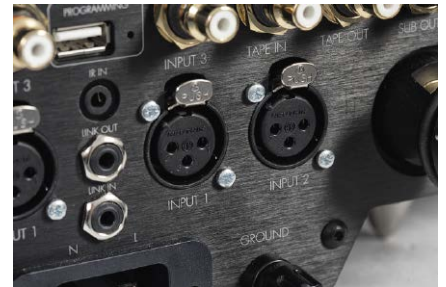
Podstawowymi wejściami analogowymi są XLR-y pozwalające wykorzystać atuty układu zbalansowanego.
